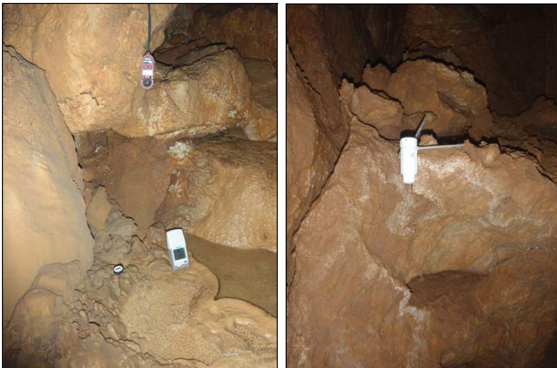
Slika 12. Mjerenje temperature i vlage zraka, i udjela CO 2 , foto R. Ozimec Slika 13. Termohigrometar Hobo Pro v2, foto R. Ozimec
