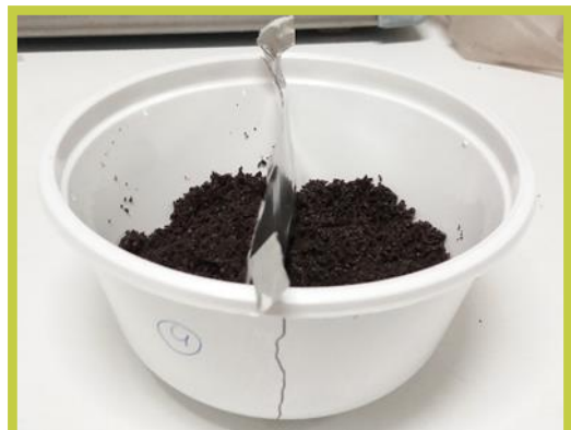
FIGURA 2. Preparação do sistema de teste com divisória para colocação de solo controlo e contaminado, nos dois lados opostos.
