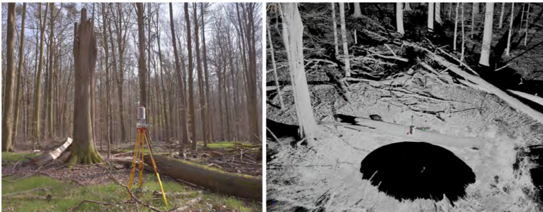
Figure 4: Laser scanning van een recent afgebroken beuk in het Zwaenepoelreservaat met links de opstelling van de scanner en rechts het resultaat als puntenwolk. De zwarte delen zijn de 'schaduw' die niet gescand is vanaf deze ene positie zoals de directe omgeving onder de scanner en de zone achter het liggend dood hout. Om die 'schaduw' weg te werken scannen we vanaf verschillende posities.
